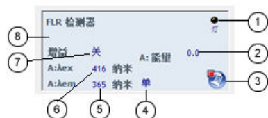
图 3-7： FLR 检测器控制面板
